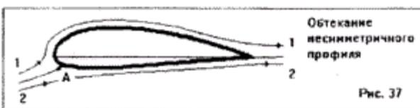
Рассмотрим две струйки воздуха, обтекающие верхнюю и нижнюю поверхности профиля. Профиль обтекается без завихрений. Молекулы воздуха в струйках 1 и 2, подходящие одновременно к передней кромке крыла, должны также одновременно отойти от задней кромки. Из рисунка видно, что длина траектории струйки воздуха, обтекающей верхнюю поверхность профиля, (1) больше, чем длина траектории обтекания нижней поверхности (2). Над верхней поверхностью молекулы воздуха
